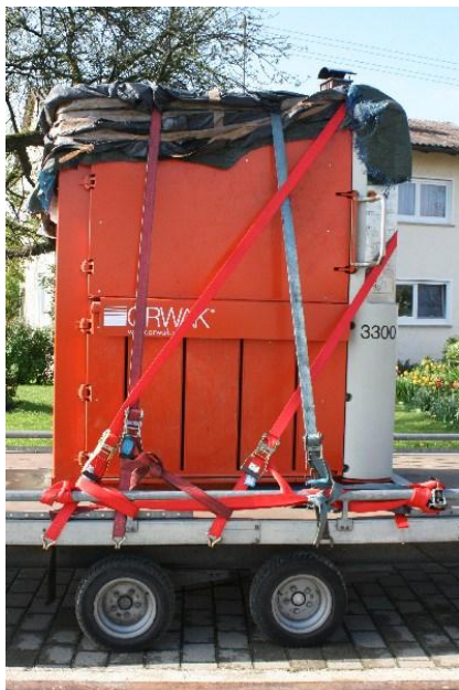
Abb1,2. Mit einer mobilen Presse vor Ort werden sortenreine Fraktionen sofort verpresst
